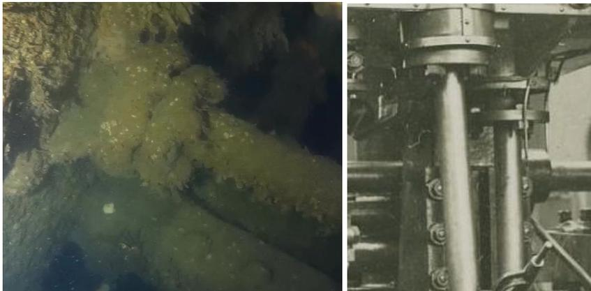
Dies ist die Einführung der Kolbenstange in den Zylinder. Man erkennt auch die selben Schrauben im Hintergrund. (Im rechten Bild ist der Maschinenständer davor).
